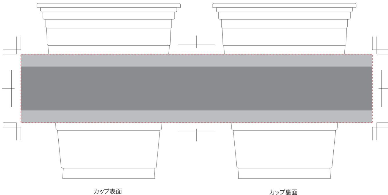
**成型されたカップに印刷を行う曲面印刷です。**
